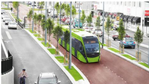
Mynd 3.1 Miðlægt BRT, vagn ekur á sérreinum í miðju.
