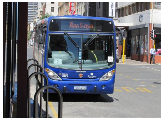
Mynd 7.3 BRT vagn keyrir eftir leiðbeinandi línu, sjá gula línu (ITDP, 2014).
